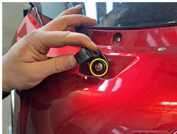
Irrota tuulilasinpyyhkijän kiinnitysmutteri. (hylsy 10 mm).
