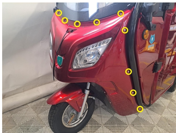
Irrota etukatteen kiinnitysruuvit kummaltakin sivulta ja tuulilasin edestä. (ristipäämeisseli ph2).
